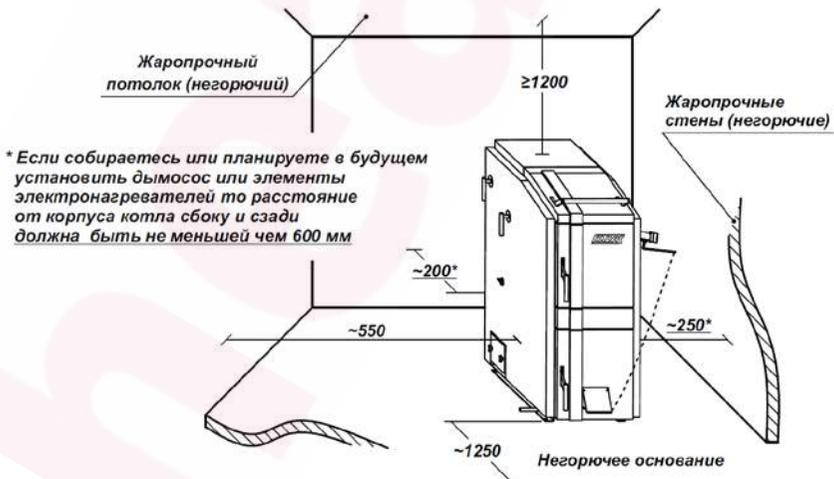
Котел надо установить вертикально или с наклоном вперед не более чем  $1^\circ$ . Пол помещений должен быть ровным, негорючим, способным выдержать нагрузку до  $0,7 \text{ т/м}^2$ . Высоту установки котла (горизонтальность) можно отрегулировать болтами, используемыми для крепления котла к поддону.
