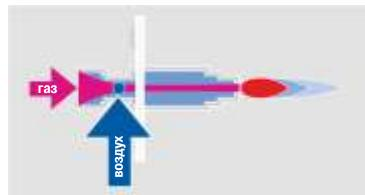
Принцип атмосферного сжигания газа: Газ автоматически подается в горелку вместе с атмосферным воздухом, необходимым для горения. При этом не нужно использовать электрический вентилятор, как это требуется в других отопительных котлах. Преимущества, которые Вы получаете от использования такой технологии: отсутствие дополнительного потребления электроэнергии и значительное снижение шума отопительной установки.
