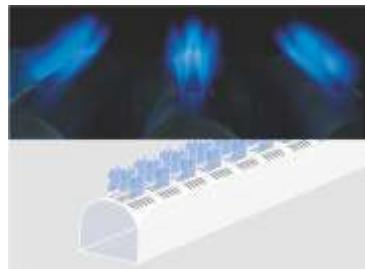
Благодаря специальной конструкции горелки, горение происходит в виде множества отдельных факелов. Этим достигается равномерный нагрев теплообменника котла, предотвращая перегрев трубок горелки.
