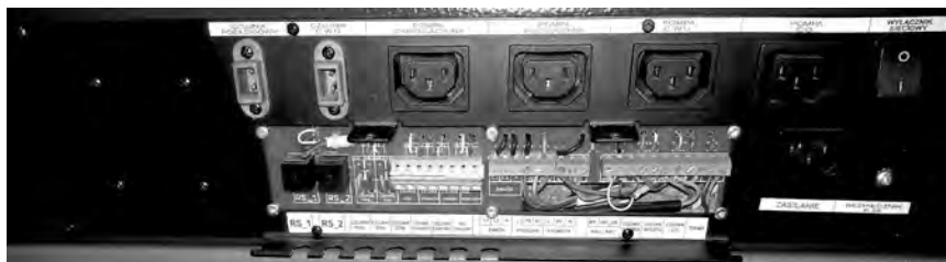
Rysunek 2 Listwa przyłączeniowa do zasilania urządzeń regulacyjnych (uwaga fot. przedstawia przykładowe rozmieszczenie podłączeń, szczegóły w dołączonej DTR sterownika).
