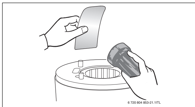
Рис. 52 Проверка наличия грязи в теплообменнике
